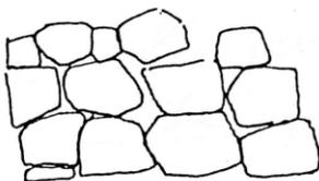
Appareillage de moellons assisés
