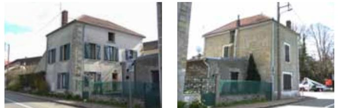
VARIANTE 2 - Les baies ne suivent pas un axe de symétrie. L'entrée se fait par le jardin. Dans les deux cas le parement de façade n'est pas adapté : enduit en surépaisseur et enduit disparu.
